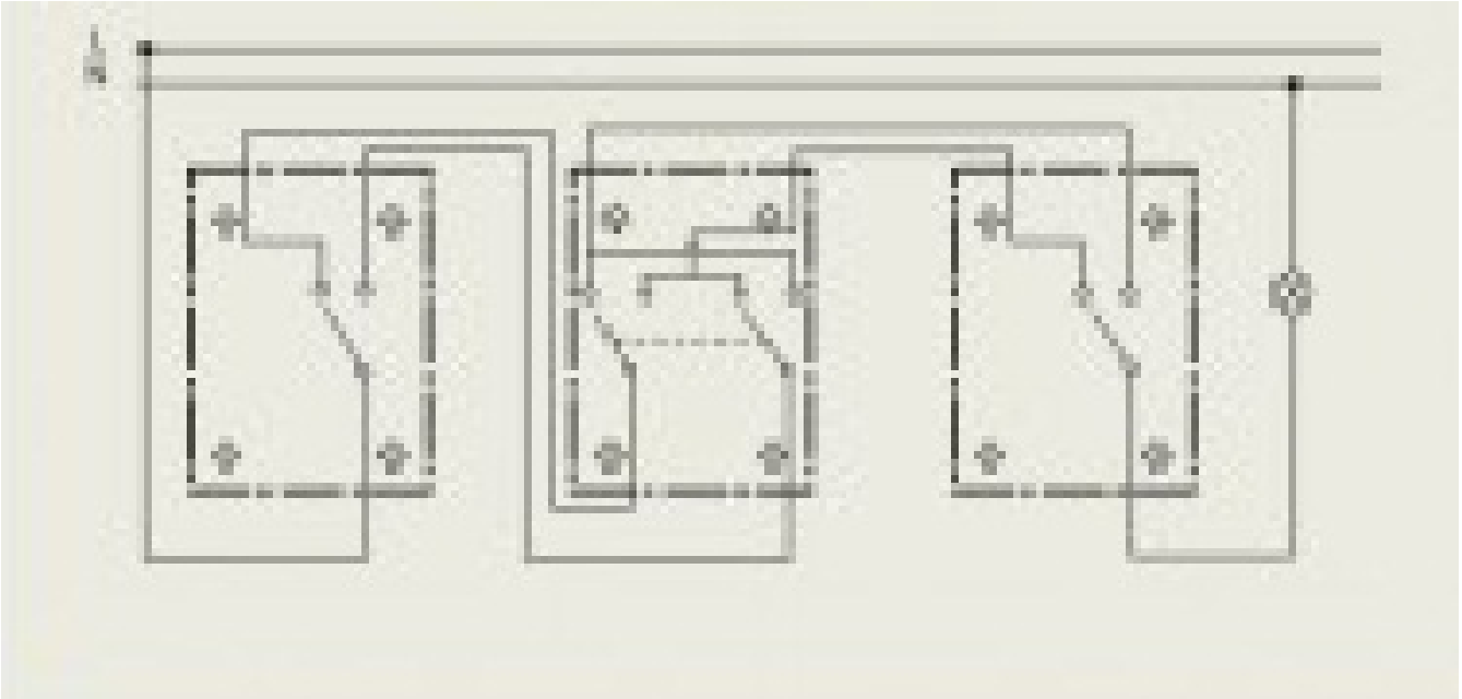
Схема подключения проходного выключателя с двумя переключателями в одной цепи
